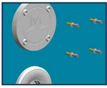
Insérez l'ensemble des vis dans les trous. Serrez les vis à l'aide d'une clé de 10 et ce jusqu'à la butée.
