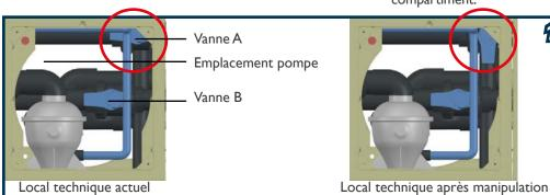
Dans le local technique intégré, fermez la vanne A (comme figure de droite) et laissez la vanne B ouverte.
