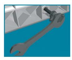
Serrez les vis à l'aide d'une clé de 10 et ce, jusqu'à la butée.
