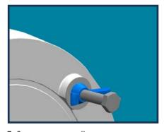
Enfin, serrez manuellement et fermement les papillons.
