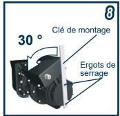
A l'aide de la clé de montage, serrez fermement l'électropompe dans sa volute.
