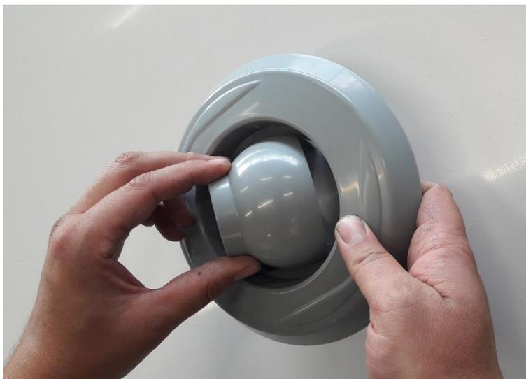
**3/ Appuyer sur la buse avec le creux de la main jusqu'à sentir la buse descendre dans l'enjoliveur refoulement**
