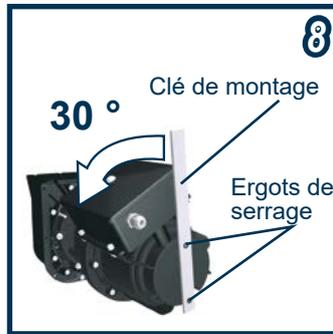
A l'aide de la clé de montage, serrez fermement l'électropompe dans sa volute.
