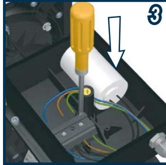
Enfoncez les poussoirs du bornier et insérez les fils. Brancher aussi le capteur de pression (domino). Testez la bonne tenue de chaque fil.
