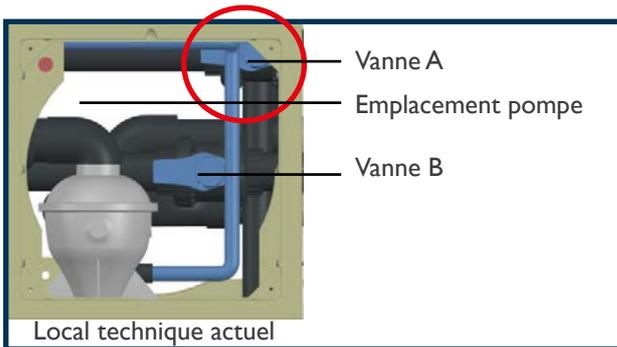
Dans le local technique intégré, fermez la vanne A (comme figure de droite) et laissez la vanne B ouverte.
