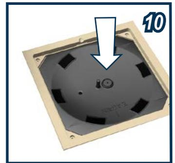
Remplacez l'isolant acoustique en gardant l'orientation « bassin » vers le bassin et en glissant le tuyau d'évacuation dans le trou du compartiment moteur. Refermez et verrouillez le compartiment.
