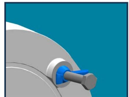
Enfin, serrez manuellement et fermement les papillons.
