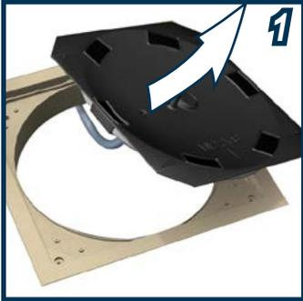
Ouvrez le compartiment de l'électropompe et retirez l'isolant acoustique.
